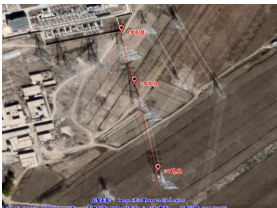
1、2、3 塔基 2018 年 10 月组塔施工遥感影像
