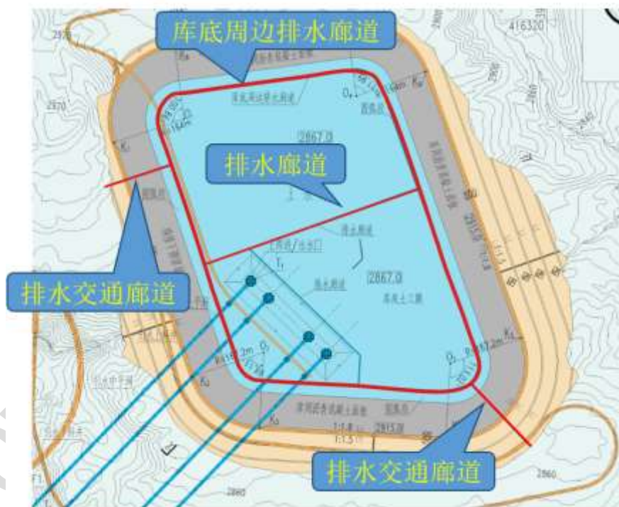
图 2.8.5-1 上库大坝排水廊道布置示意图
