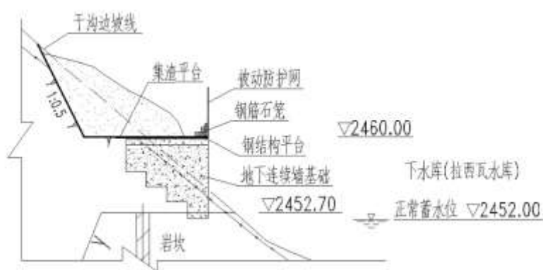
图 2.8.6-3 集渣平台横剖面示意图
